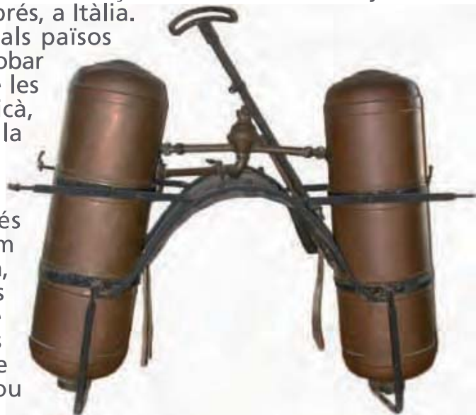
Bomba amb manxa utilitzada per ensofrar els ceps
